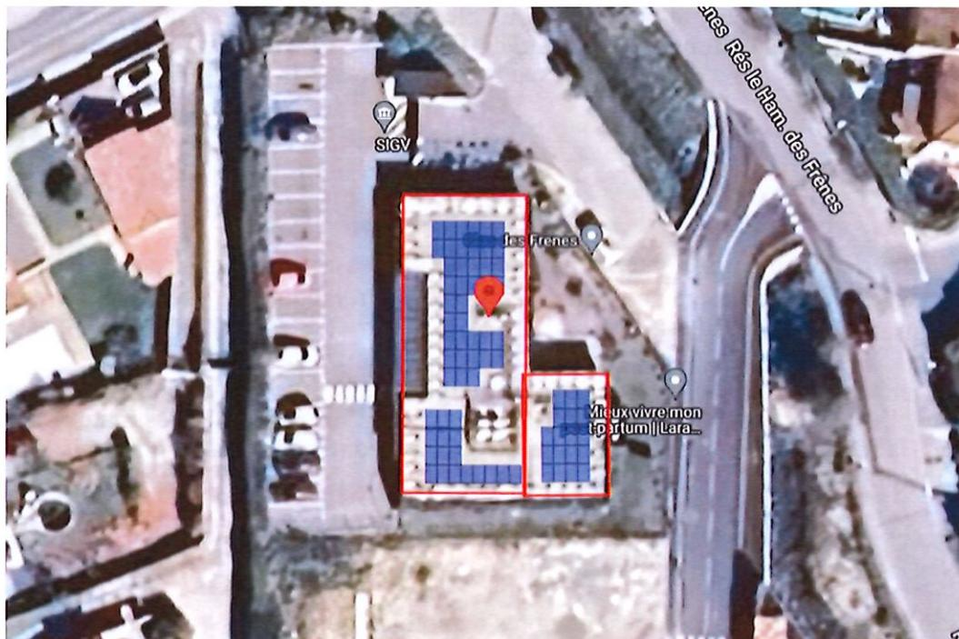
Le mode de valorisation de l'électricité envisagé est l'autoconsommation, avec une puissance de l'installation possible de 32.56 kWc et une production annuelle de l'installation (approximative) de 41 670 kWh.
